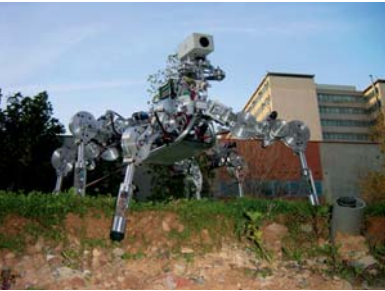
Robot dotato di 6 zampe che ne assicurano una buona stabilità. Lo spostamento avviene muovendone 3 alla volta in modo tale che ve ne siano sempre 3 a garantire la stabilità statica.
