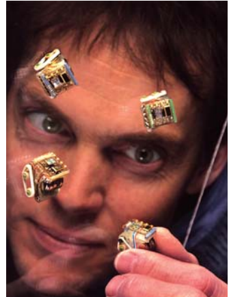
Micro robot in grado di cooperare ad un obiettivo comune mostrando quindi un comportamento complessivo che trascende quello del singolo robot.
