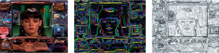
Elaborazione di immagine per separare gli oggetti che la compongono tramite evidenziazione di linee di contrasto. A sinistra l'immagine catturata, in mezzo la evidenziazione delle linee che potrebbero segnare la separazione tra oggetti e a destra una ulteriore elaborazione per separare in modo preciso i diversi componenti.
